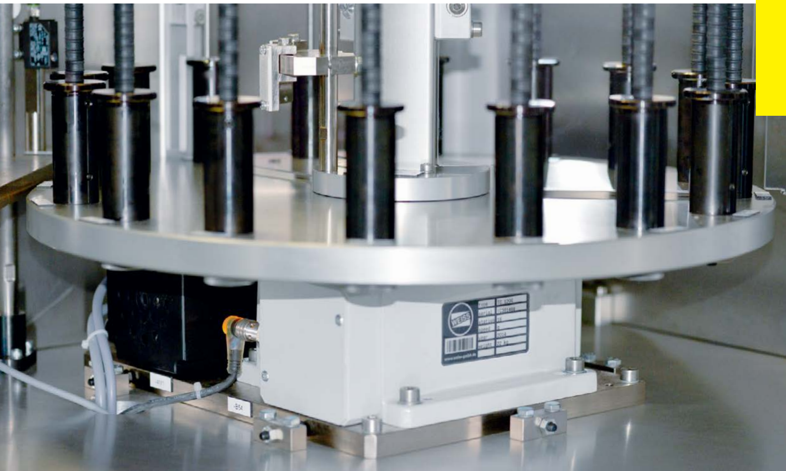
자동차부품 생산장비. 인젝션펌프용 씰링 조립라인으로서 고정도가 요구됩니다. 당사의 TC 150과 회전판이 사용되어 요구되는 고정도를 충족하였습니다.
